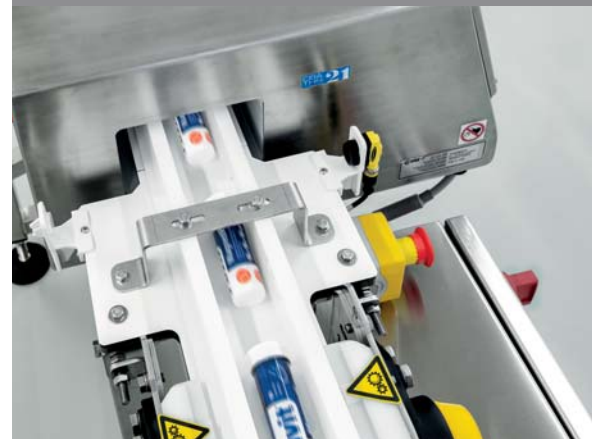
THS/FBB per l'ispezione di tubi di compresse e confezioni per medicinali.
