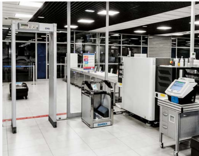
Ispezione dei passeggeri mediante metal detector a transito (WTMD), analizzatore di scarpe (SAMDEX) ed ispezione corporale mediante rivelatore di tracce di esplosivo (ETD)
