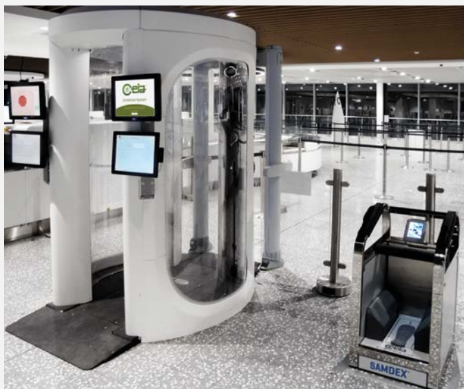
Ispezione dei passeggeri mediante sistema combinato (WTMD e SSc) ed analizzatore di scarpe (SAMDEX)
