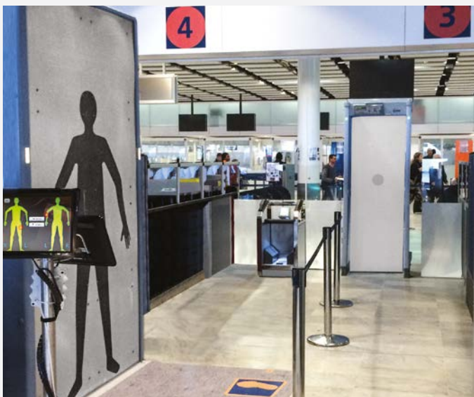
Ispezione dei passeggeri mediante metal detector a transito (WTMD), analizzatore di scarpe (SAMDEX) ed ispezione corporale mediante scanner di sicurezza (SSc)
