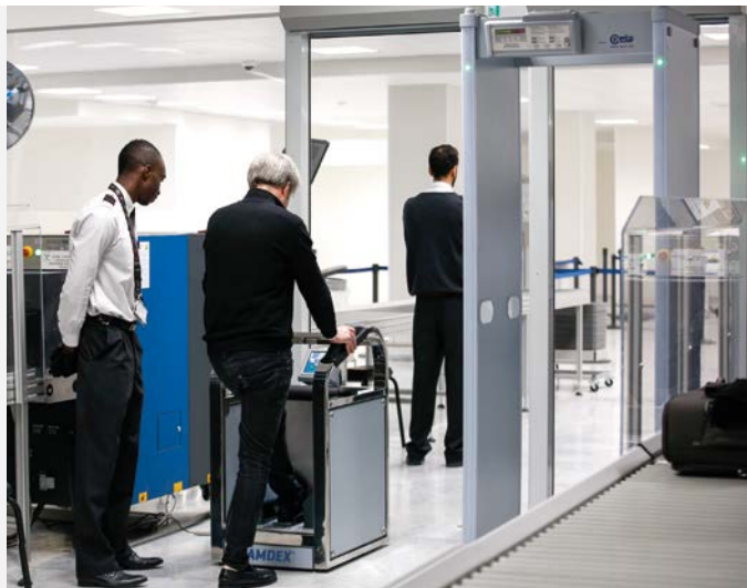
Ispezione dei passeggeri mediante metal detector a transito (WTMD) ed analizzatore di scarpe (SAMDEX)
