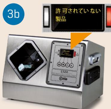
3b ボトルの内容物が安全でないと判定されれば、赤いライトと警報メッセージが表示される。大きく長いピープ音も装置内部から発せられる。
