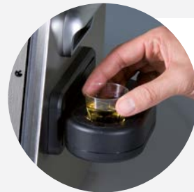
EINSETZEN DES PROBENBECHERS IN DIE EXTERNE ANALYSEEINHEIT
