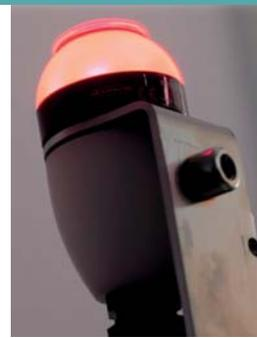
Oltre alla funzione AUTOTEST, i rilevatori THS/21ET, THS/21 e THS/MS21 possono essere **programmati in modo che le verifiche periodiche della calibrazione vengano eseguite automaticamente. Questa funzione è chiamata AUTO-QC™ TEST.**
