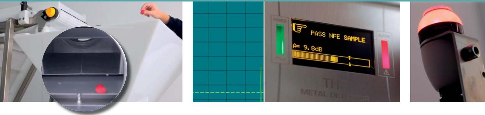
Además de la función AUTOTEST, los detectores THS21ET, THS/21 y THS/MS21 pueden programarse para que se realicen automáticamente verificaciones de calibración periódicas. Esta característica se llama **TEST AUTO-QC™**.
