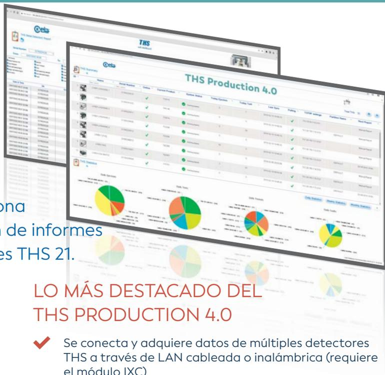
El software THS Production 4.0 proporciona capacidades de adquisición y generación de informes para los sistemas de detección de metales THS 21.
