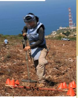
La centrale elettronica può essere trasportata a tracolla, inserita alla cintura, mediante appositi ganci di sostegno, o integrata nel palo telescopico
