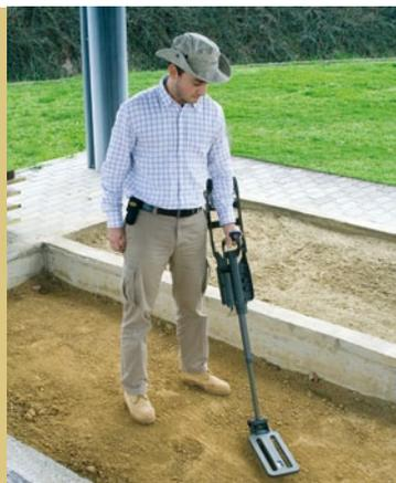
BETRIEBSPRÜFUNG AUF EINEM MINERALISIERTEN VERSUCHSBODEN BEI DER FIRMA CEIA
